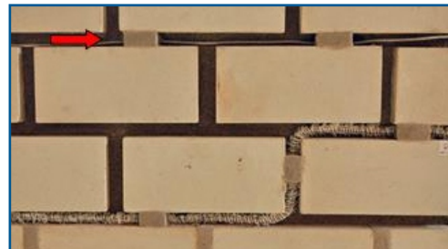
Einbauvarianten der textilen Sensorschnur ins Mauerwerk
