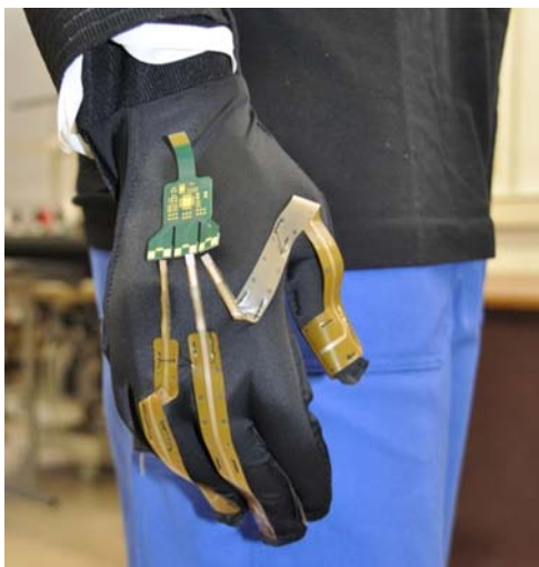
Abbildung 2: Sensorintegration von Foliesensoren (Würth Elektronik) am Handschuh
