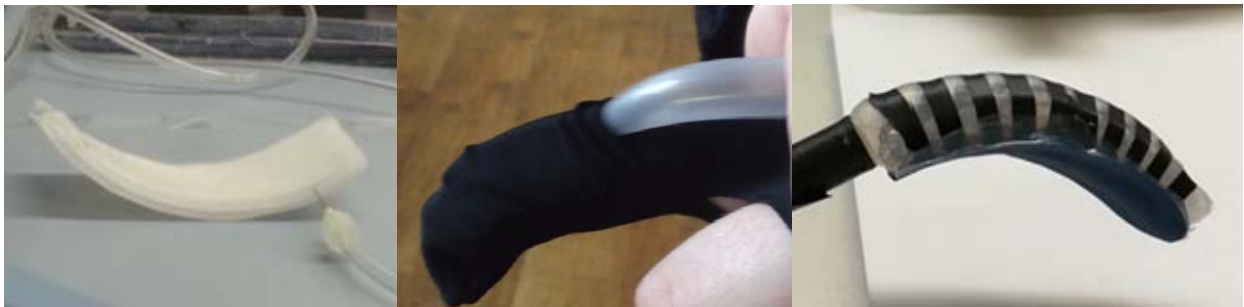
Abbildung 1: Darstellung von 3 unterschiedlichen Aktorprinzipien (v.l.n.r.: pneumatisches Abstandsgewirke, textilummantelter Silikonschlauch, textilverstärkter Silikonguss)
