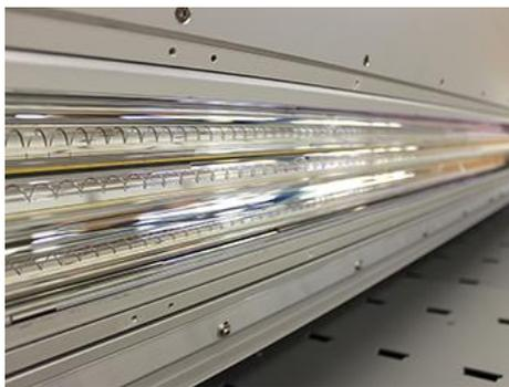
*Bildunterschrift: Mittels Excimer-Technologie können hochresistente und extrem matte Oberflächen erzielt werden.*
