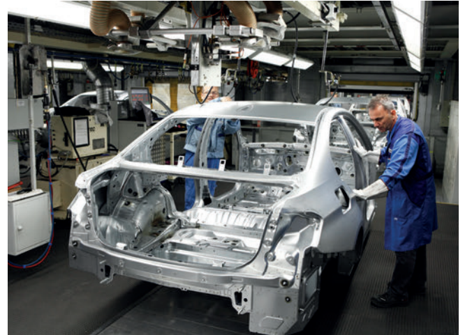
Abb. 4: BMW 3, Montage Produktionsstart; © BMW AG
