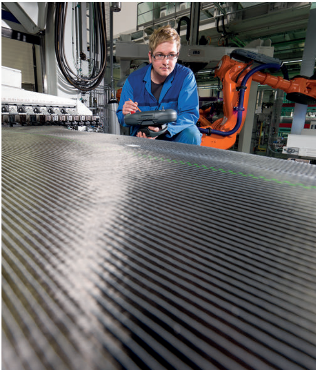
Abb. 11: Qualitätsprüfung an einer Preform Maschine für CFK Komponenten; © BMW AG
