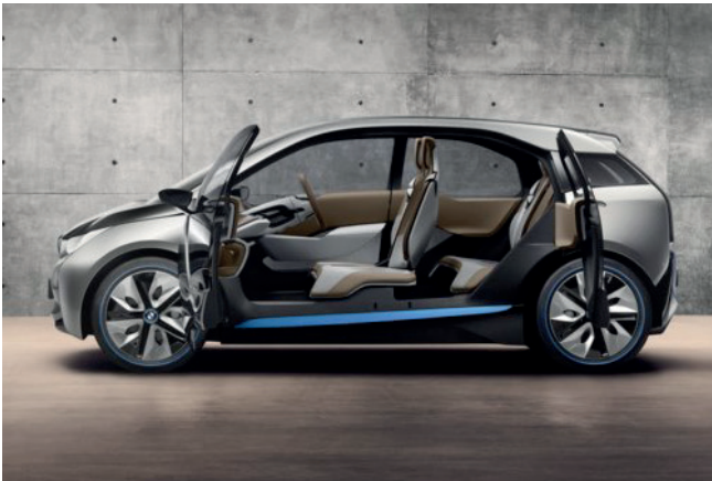
Abb. 13: BMW i3 Concept, Elektrofahrzeug mit CFK Karosserie; © BMW AG
