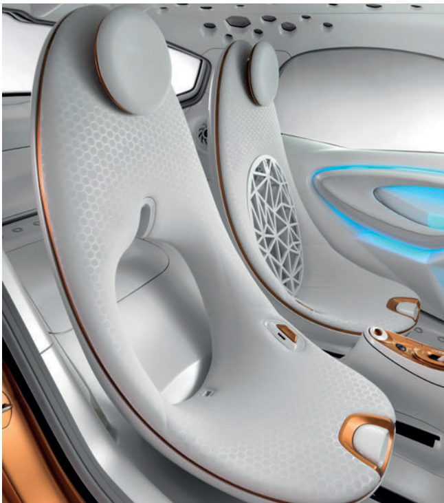
Abb. 8: Multifunktionale Kunststoff-Leichtbau-Komfortsitze im smart forvision; © Daimler AG
