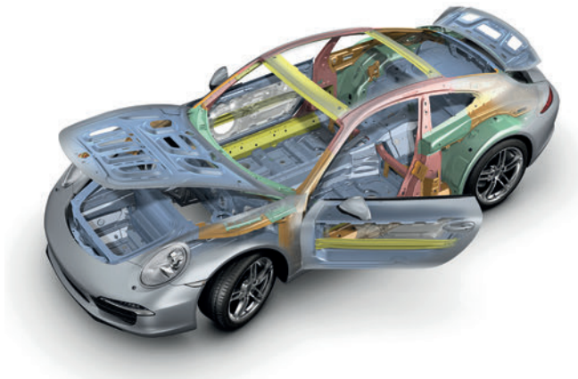
Abb. 5: Porsche 911, Leichtbaukarosserie mit intelligentem Werkstoffmix; © Porsche AG
