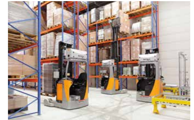
Abbildung 45: Selbstfahrende Schubmaststapler im Logistikzentrum. (Quelle: © STILL)
