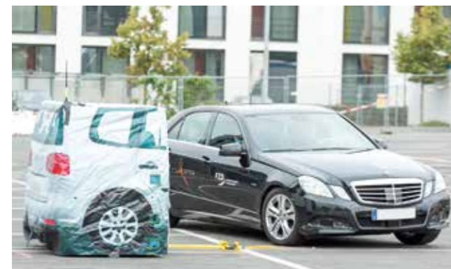
Abbildung 20: Technikdemonstration neuer Testverfahren für Fahrerassistenzsysteme und automatisiertes Notausweichen bei kreuzendem Verkehr. (Quelle: KO-FAS, www.ko-fas.de (2015))
