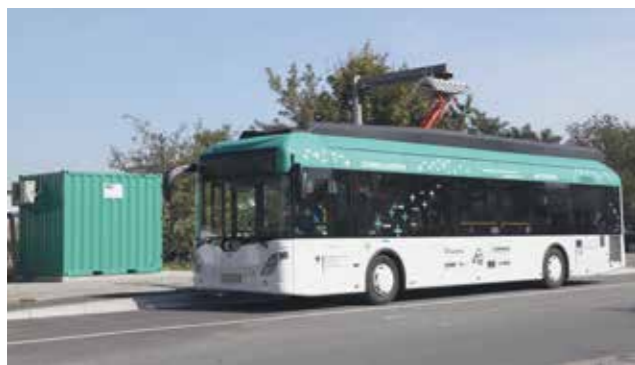
Abbildung 41: Automatisiertes Laden im ÖPNV. (Quelle: Fraunhofer IVI)
