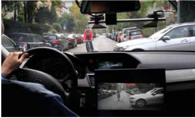
Abbildung 21: Demonstration der Erkennung und Darstellung von schwächeren Verkehrsteilnehmern. (Quelle: Projekt UR:BAN, www.urban-online.org (2015))
