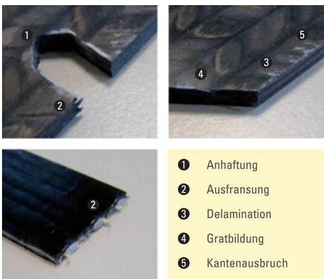
Abbildung 12: Schädigungsmechanismen und -bilder bei der Zerspanung von CFK-Werkstoffen 13
