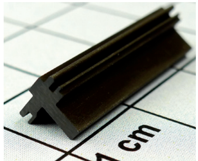
Abbildung 7: Beispiele für keramische Bauteile. Erodirtes Zahnrad (oben) und drahtgeschnittener Schneidstempel aus DIMACER® (ZTA-TiC) (unten) 9
